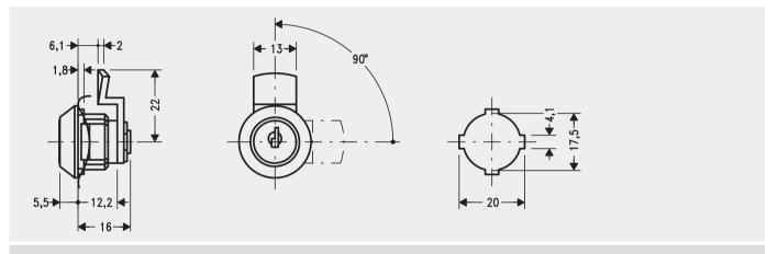
Ausführung: Renz Zylinder: Zink-Druckguß, glanzverchromt. 5 Plättchenzuhaltungen. Schließweg 90°. 2 DOM Schlüssel, Stahl, 2 mm stark, vernickelt. Schlüssel nur in Sperrstellung abziehbar.
