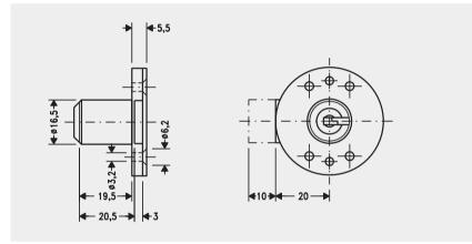
Zylinder und Anschraubplatte: Zink-Druckguß, matt vernickelt. 5 Plättchenzuhaltungen. Schlüssel-Drehweg 180°. Riegelausschluß 10 mm.
